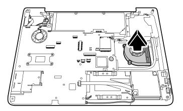
Figure 4-61 Removing the fan
